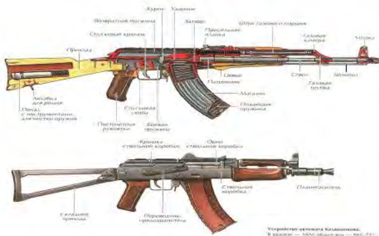
Рис. 1 Устройство АК. В разрезе – АКМ. Общий вид – АКС-74У
